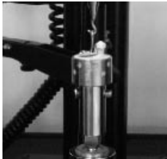
รูปที่ 4 ขอเกี่ยวโลหะดึงห้วงยึดที่ติดกับโครงโลหะผสมโครบอลท์-โครเมียม
