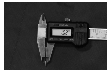
รูปที่ 4: ตรวจสอบความหนาของชิ้นงานด้วยเครื่องวัดดิจิตอล
