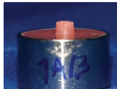
รูปที่ 3 แสดงชิ้นทดสอบที่ถูกยึดด้วยเรซินอะคริลิกชนิดบ่มด้วยตัวเอง
