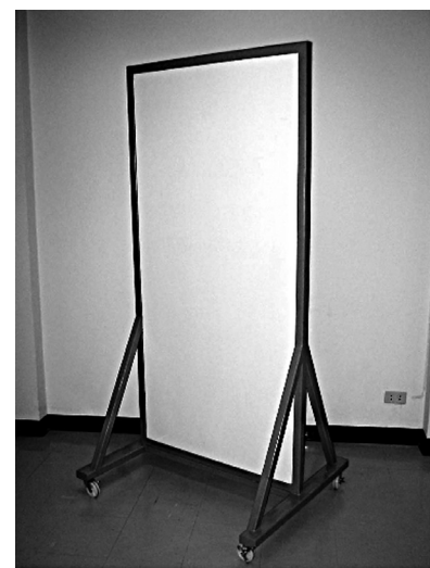
รูปที่ 5 แสดงฉากกั้นรังสีที่สร้างจากแผ่นสังกะสีจำนวน 12 แผ่น ที่มีแผ่นไม้อัดประกบบริเวณด้านหน้าและหลัง
