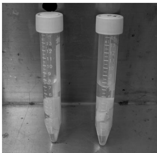
รูปที่ 3 ชิ้นตัวอย่างที่แช่ลงในน้ำเกลือหลังจากเขย่าแล้ว Figure 3 The specimens in the saline solution after vibrating
