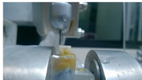
รูปที่ 3 แสดงการใช้งานเครื่องกรอฟันที่ควบคุมด้วยระบบคอมพิวเตอร์สำหรับเตรียมโพรงฟัน
