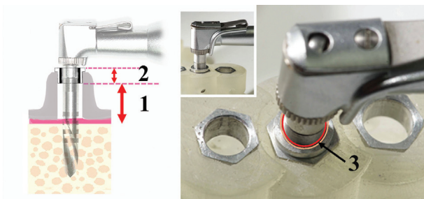
รูปที่ 2 ปัจจัยที่ส่งผลให้เกิดข้อผิดพลาดเชิงกล ได้แก่ 1) ระยะระหว่างปลอกโลหะกับกระดูก 2) ความสูงของปลอกโลหะ และ 3) ระยะที่ต่างกันของเส้นผ่านศูนย์กลางปลอกโลหะกับก้านของหัวเจาะรากเทียม (13)
